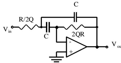
Fig. 6.6 Band Pass Filter
