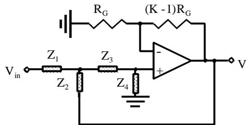
Fig. 6.4: Sallen-Key Equal Component Value Filter
