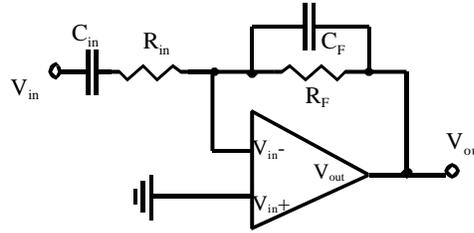
Fig. 6.3: Band Pass Filter
